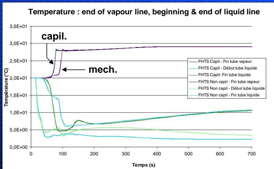
**THE VAPOUR FRONT MOVES EVEN FASTER WITH CAPILLARY PUMPS**
